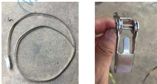
ภาพประกอบที่ 18. ต้นแบบอุปกรณ์ฯ ที่ผ่านการคัดเลือกและ Stainless Steel Bands and Buckles
