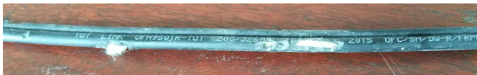
ภาพประกอบที่ 11. สาย Round Type ปกติที่ชำรุดเสียหายจากสัตว์กัดแทะ
