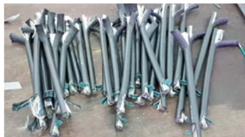
ภาพประกอบที่ 16. สายตัวอย่าง ARSS OFC เพื่อวัดค่าความต้านทาน Corrugate Armoured Steel
