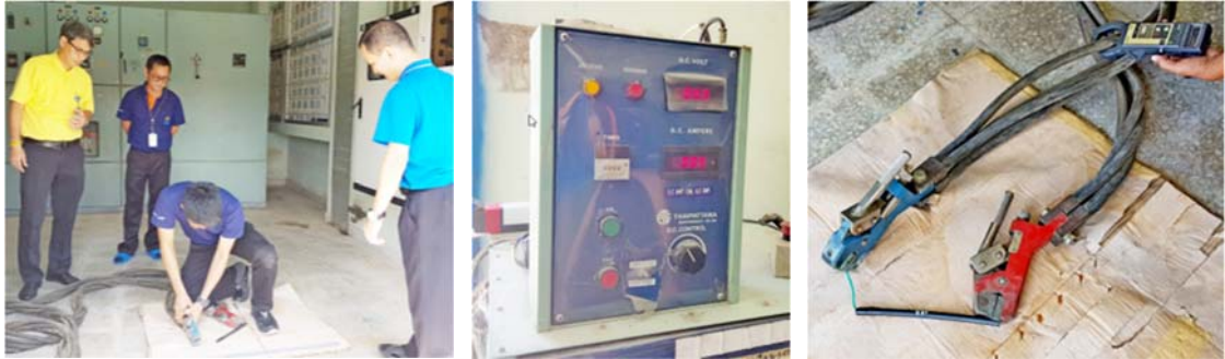
ภาพประกอบที่ 19. ทดลองจุดต่อฯ ด้วยเครื่อง High Current
