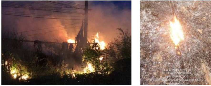
ภาพประกอบที่ 2. สายเคเบิล OFC ชำรุดเสียหายจากไฟไหม้ป่า
